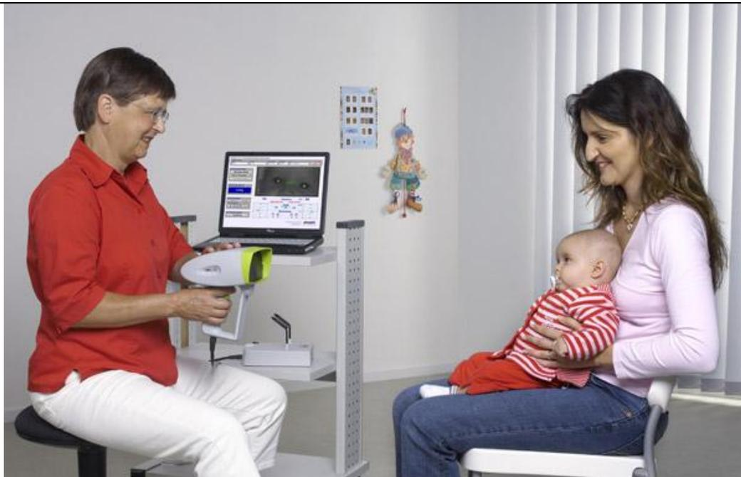
Аutoreфрактометр Plusoptix A09 — это оптико-электронный портативный измерительный прибор, который позволяет в реальном времени измерять рефракцию, размер зрачка,
